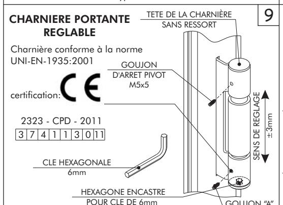
Pour caler la porte en hauteur, desserrer le goujon « A », insérer une clé hexagonale 6 mm dans son emplacement et réaliser le réglage, ensuite, serrer le goujon.
