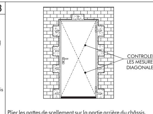
Plier les pattes de scellement sur la partie arrière du châssis. Insérer la porte complète, ou le contre-châssis, dans le logement du mur, en respectant la hauteur du plancher fini. Pour garder la porte en position utiliser des coins en bois. Les placer en respectant le niveau du plancher, l'aplomb et les diagonales.
