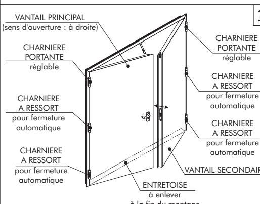
Schéma disposition charnières. Il est possible de régler la serrure et la contre-serrure dans le sens indiqué par les flèches. Une fois le montage conclu, retirer l'entretoise au sol.
