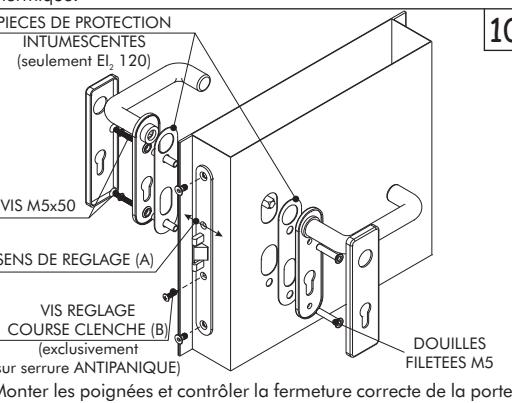
Monter les poignées et contrôler la fermeture correcte de la porte. Si l'ouverture du loquet nécessite trop d'effort, déplacez la serrure en suivant la flèche (A) et tournez la vis de réglage du loquet (B). N.B. La figure montre une serrure incendie et le réglage de la serrure.
