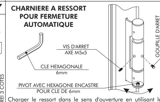
Charger le ressort dans le sens d'ouverture en utilisant la clé hexagonale 6 mm (au maximum 1/4 de tour), placer le cliquet d'arrêt dans le trou correspondant et bloquer le tout avec un grain de serrure. Essayer la fermeture automatique minimum 45° d'ouverture. Si la porte ne se ferme pas, la porte a besoin d'un ferme-porte ou elle n'est pas correctement installée.
