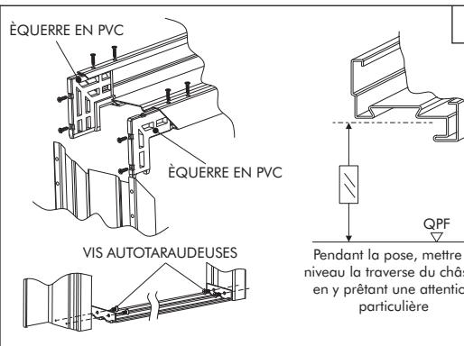
Au cas où le châssis arrive en kit, il faut l'assembler en unissant les montants et la traverse au travers des équerres en PVC spécifiques. Visser l'ensemble.
