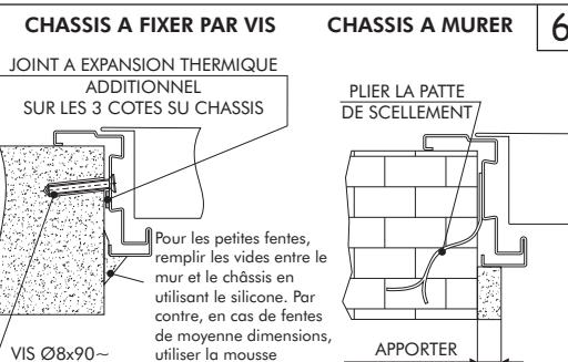
Murer les pattes de scellement et le châssis en utilisant le mortier de ciment à prise rapide. Remplir les vides restant entre le châssis et la paroi en utilisant le colgrout. Au cas où les pattes de scellement ne pourraient pas être murées, la version à fixer par vis doit être utilisée avec des vis Ø 8x90, du silicone feu et un joint à expansion thermique.
