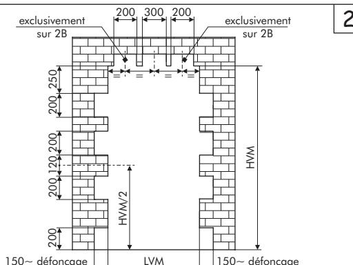
Vérifier HVM (hauteur ouverture mur) et LVM (largeur ouverture mur). En utilisant les outils adéquats, créer dans le mur les défoncages à forme sous-cadre pour la maçonnerie des pattes de scellement.
