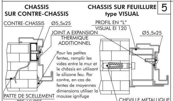
Murer le contre-châssis et les pattes de scellement correspondantes au mortier de ciment. Seulement après la prise du ciment l'on peut visser, au travers de vis Ø 5,5x25, le châssis au contre-châssis, en effectuant des trous Ø 4,5. Fixer par cheville Ø 8x80 la feuillure à la paroi. Visser, en utilisant des vis Ø 5,5x25, fixer le châssis à la feuillure type VISUAL.
