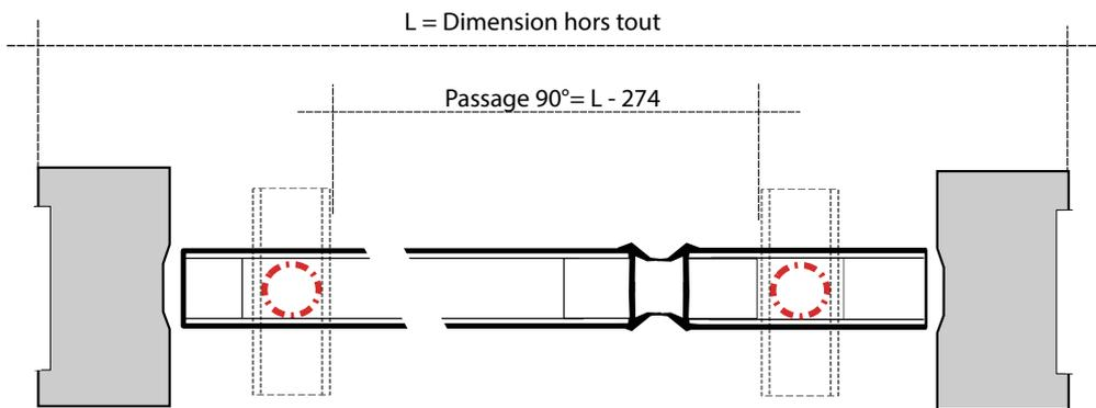
**Vantail** : D'épaisseur 50 mm, le vantail de notre porte coupe feu bois 1h, en un ou deux vantaux se compose d'un cadre en bois (pin, chêne, hêtre ou bois exotique) supportant une âme en lin prise entre deux panneaux médium bois. La finition est brute ou stratifiée. L'étanchéité est assurée par un joint graphite. Un pivot GRL 100 (GROOM) est intégré dans le linteau, crapaudine en partie basse (au sol ou encastrée)
